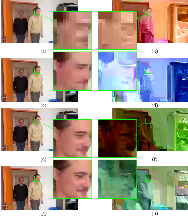
FIGURE 7 – Résultats de la compression et crypto-compression (à différentes résolutions) sur la frame #45 de la vidéo Office avec QP = 36 : frames compressées en 1 ère colonne, et frames crypto-compressées en 2 ème . a) et b) En résolution QCIF ( 176 \times 144 ), c) et d) En CIF ( 352 \times 288 ), e) et f) En HD 720p ( 1280 \times 720 ) et g) et h) En HD 1080p ( 1920 \times 1080 ).
